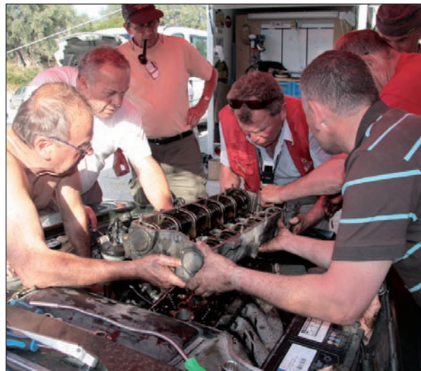
Découplage pour le 6 cylindres de la Mercedes 280 SLC de Gérard et Brigitte Leclère. Une sacrée opération de mécanique sur un modèle injection. Pour corser l'affaire, en démontant, nos mécanos Pascal, Philippe et Camille s'aperçoivent que le tendeur de chaîne principal est cassé ! Mais l'auto repartira 48 heures plus tard, en bien meilleure forme qu'elle n'était arrivée.
