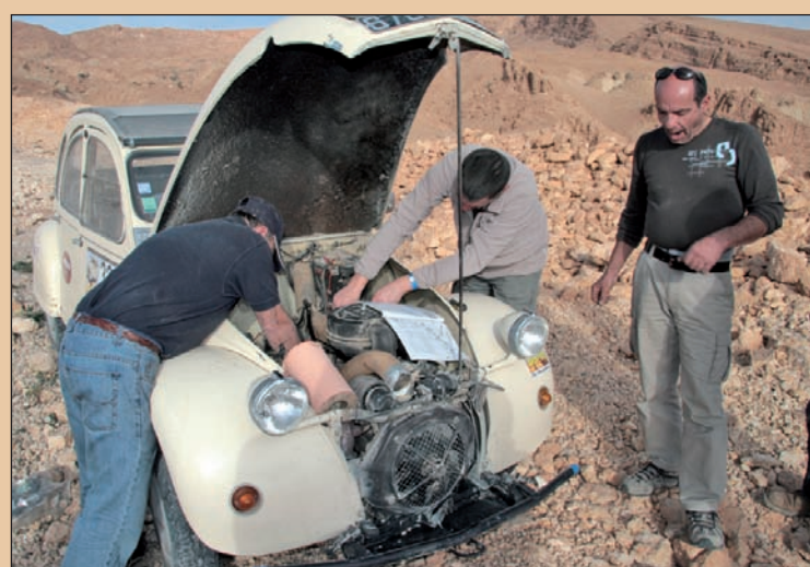
La 2 CV de Georges Popineau perd des rapports. Il faudra démonter sept fois le couvercle des fourchettes pour les retrouver, en réglant au jugé le jeu de ces satanés fourchettes, mais l'auto sera à l'arrivée. Et là, Guillaume Kunhlté procédera à un réglage à l'oreille comme on n'en a jamais vu.
