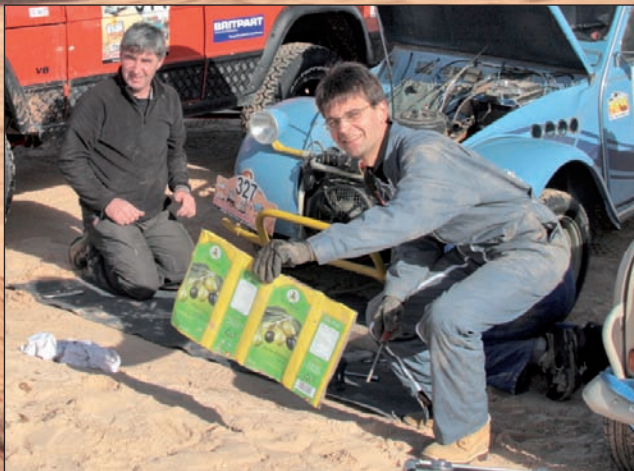
Il faut parfois savoir improviser : c'est un bidon d'huile d'olive qui va permettre à Guillaume de reconstituer l'enveloppe de l'échappement de la 2 CV des Lemarchand, déchirée par un caillou.
