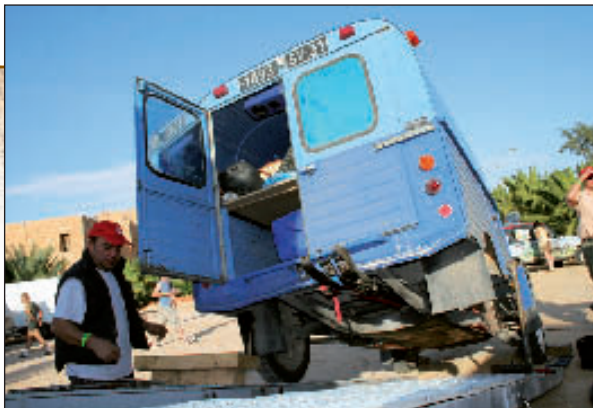
Grosse séance de mécanique pour remettre en place le bras de suspension de la 2 CV de Raymond.
