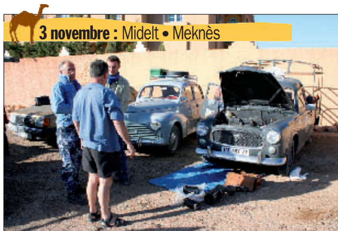
3 novembre : Midelt • Meknès Petite séance de mécanique pour Jean-Marc Rachart et sa 403 "mazout" pick-up de 1958. « La dynamo charge mal. Je vais la changer et j'en profite pour nettoyer le filtre à air. »
